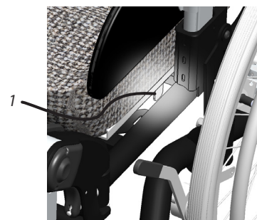
Kuva 20. Vipua (1) istuimen syvyyssuunnan säätöön on istuimen alapuolella vasemmalla.
