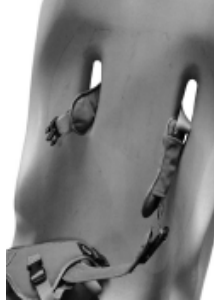
Vaihe 2 Vedä hihna selkänöjan poikki ja ulos oikeanpuoleisesta yläaukosta.
